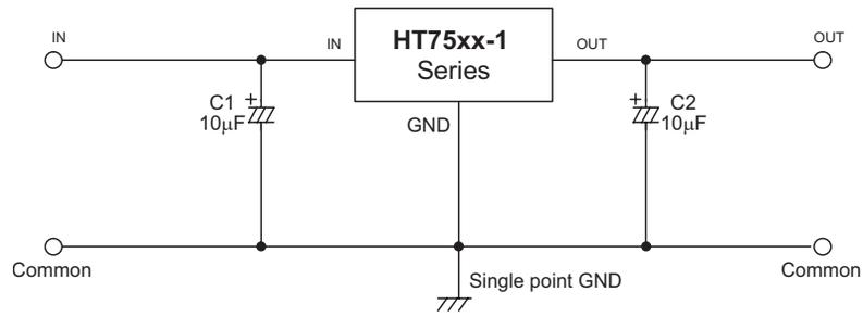
大电流输出正电压调节器
