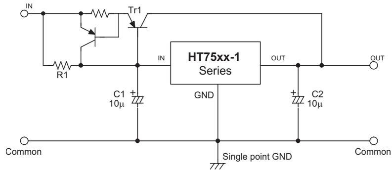
用于增加输出电压的电路
