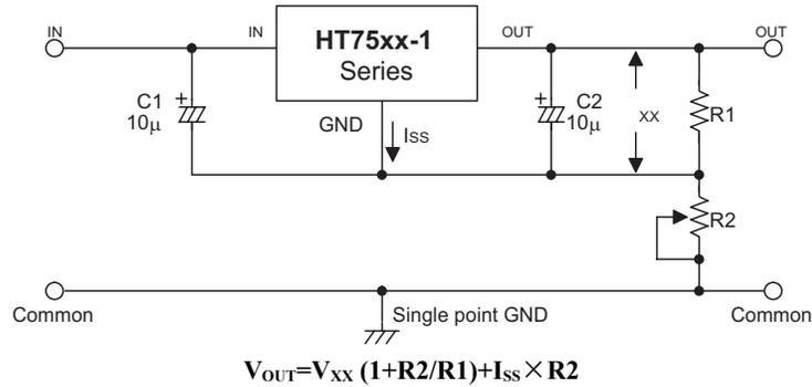
用于增加输出电压的电路
