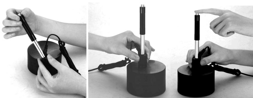
向下推动加载套锁住冲击体；对于 DC 型冲击装置，则可将加载杆吸于试验表面，将 DC 型冲击装置插入加载杆，直到停止位置为止，此时就完成了加载。
