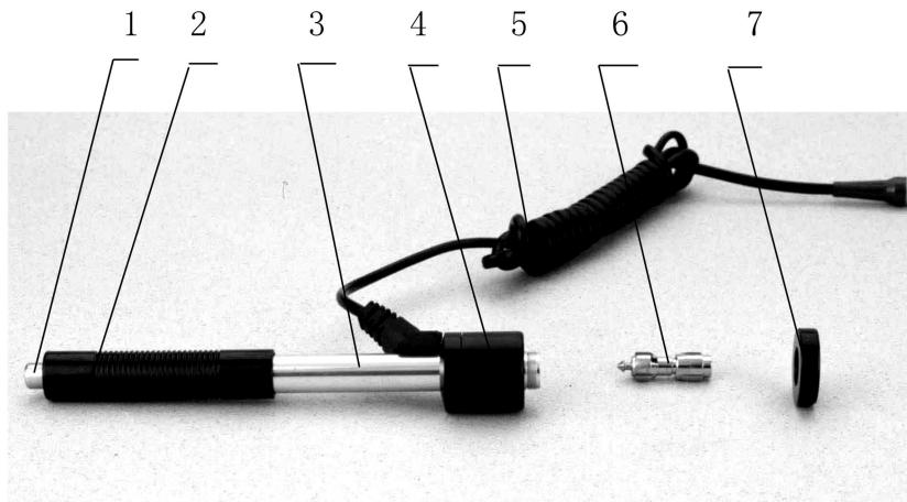
1 释放按钮 2 加载套 3 导管 4 线圈部件
