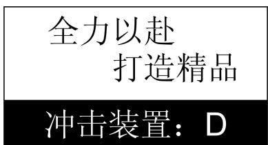
仪器会检测冲击装置类型并显示，此时请注意观察是否正确，然后进入测量主显示界面。
