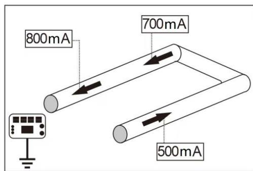
如果管道以环形方式铺设，那么在管道的所有位置和管道防腐层相同的情况下，A 点测得的电流为 0。
