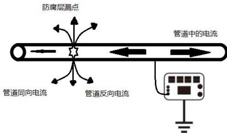
在实际测量过程中，会将所测的结果进行分析，排除管道上检测到的磁场与其他信号路径的影响。以上图为例：
