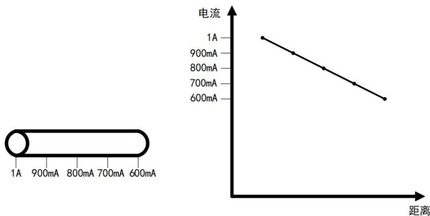
②、管道防腐层不良的管道电流损耗会急剧下降。
