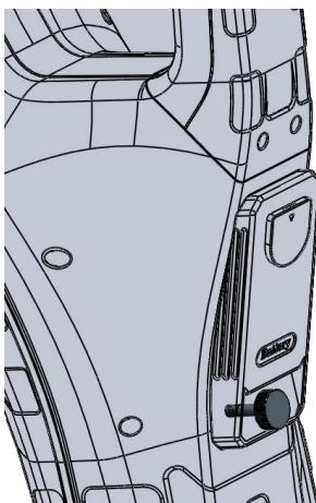
**注意：在拧螺丝时，请将电池仓朝上，防止电池仓滑落摔坏。**
