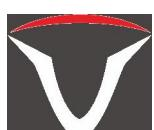
宽峰+谷值模式：宽峰+谷值+导向箭头+罗盘，有效信号区域最宽，适合寻找管线的大致位置，最大值不好确定，不适合精确定位
