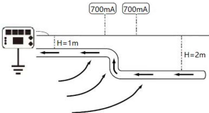
管道防腐层有破损或缺陷时，电流不是正常衰减，会陡降。故障可能由涂层或防腐层损坏、与其他设备接触等原因造成。
