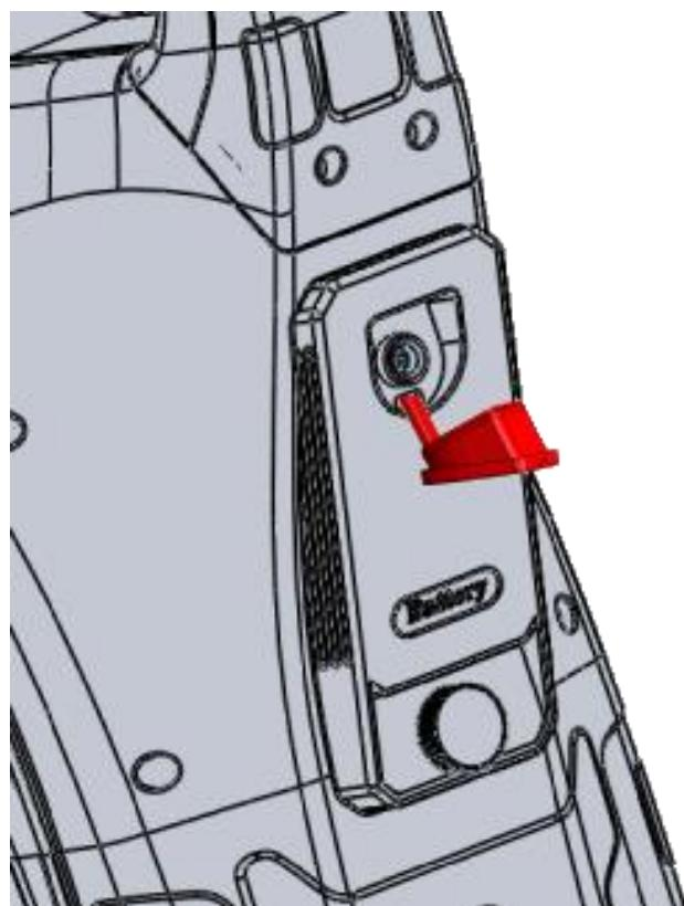
**电池更换：旋转手拧螺丝，螺丝只需要拧到脱离预埋螺母即可，电池仓上的手拧螺丝是松不脱类型，会一直在电池仓上。**
