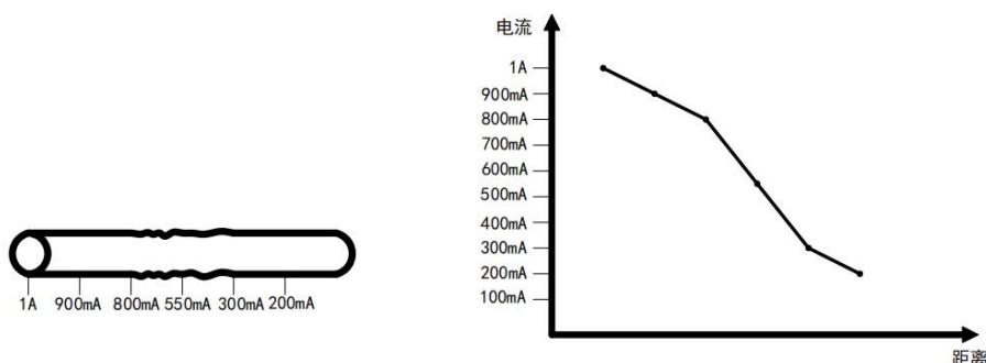
④、管道中有防腐层不良的套管时，经过此位置的电流会有一定程度的加剧损耗。
