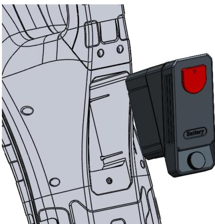
螺丝拧出预埋螺母之后，稍微用力即可从电池腔体里将电池仓拔出来。打开红色塞子能看到电池充电口，用仪器配件中的  $4.2V=2A$  的电池充电器插头插入充电口即可充电，充电器指示灯亮红灯表示正在充电，亮绿灯表示电池已充满。
