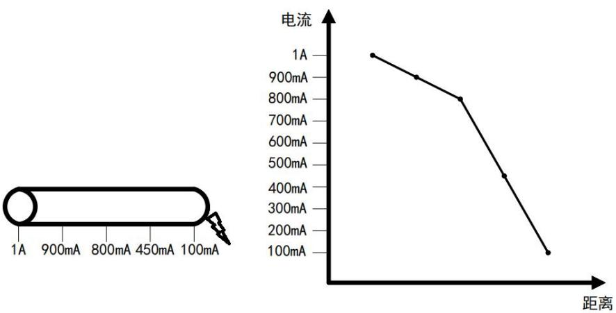
⑥、管道中防腐层良好，路面比较干燥和阻抗比较大电流损耗会急剧下降。
