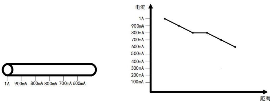
⑦、相互连通的平行管道，**A** 段管道电流损耗平稳，管道表面防腐层良好。**B** 段管道电流损耗急剧下降，说明两条管道有相互接触的点，两条管道形成了短接的状态。
