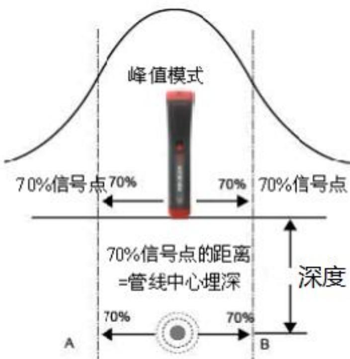
深度测量：接收机位于管线正上方时，按
