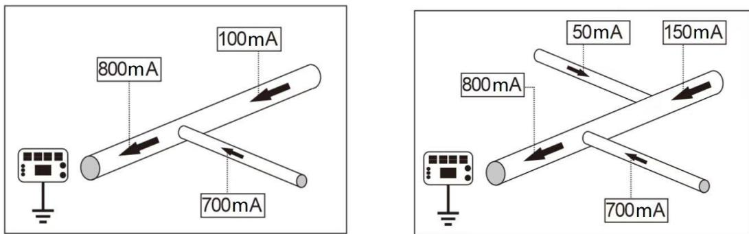
在实际探测管道过程中，可以先熟悉本地管道铺设的管道网络图，可以更好的确定发射机的连接位置，根据支路电流最大这一原理，可以很快找到防腐层故障点。
