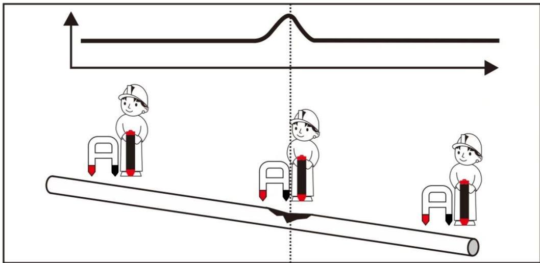
KODIN 9 系列-FM 管道防腐层探测仪支持电流衰减和 ACVG 值同时测量，可以使使用者不用多次来回测量查找故障点，通过一遍查找采集数据，即可找到是否存在故障点，减少了探测时间。
