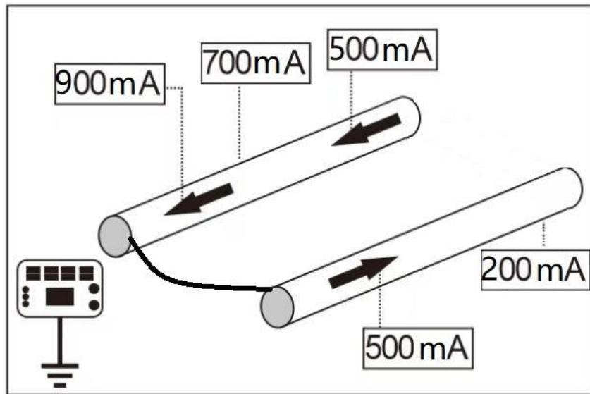
将发射机换到另一端重新测量管道电流，在相同的位置测得新管道上电流接近发射机输出值，旧管道上几乎没有电流值，当在两条管道上靠近连接点处测量电流时，电流出现在两条管道上，箭头方向相反。这表明两条管道的连接点在前面的某个位置。管道防腐层故障点就可以按照接通管道支路故障点在的支路电流越大来查找故障点。
