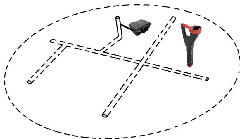
当使用峰值+模式时，旋转接收机角度，观察屏幕中的罗盘为竖直方向，在管道位置附近进行左右移动，接收机屏幕上的箭头指示会指示管线位置左右方向，距离管线较远时箭头会比较长，随着靠近管道，箭头会越来越小，条形图在距离管线较远时会比较少，随着左右移动，条形图会从小到大再到小的变化，在条形图最大的时候并且箭头最小的位置为管道的正上方。
