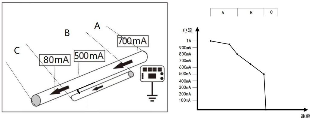
⑧、距离 3m 以上的连通平行管道，在距离发射机约 3 千米之处获得两个读数，新管道上电流比旧管道上电流明显大的多。接收机电流箭头指向发射机的方向，这表明在 3 千米内的某个地方，新管道与旧管道有相连的地方。
