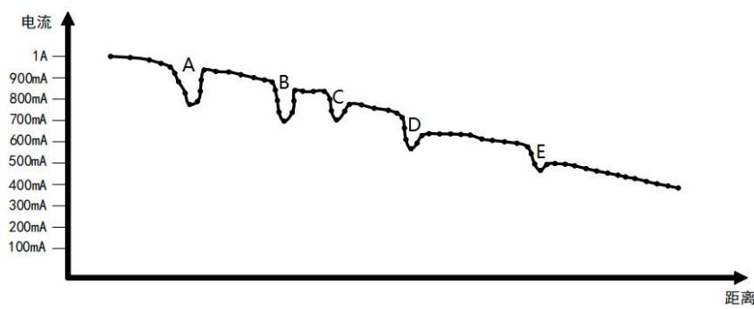
图中的“A”点，电流先急剧下降，然后回到原来的水平。这可能是由于定位信号的磁场畸变或者管道上方有另一条管道引起的。此位置可以根据施工图进一步确定。
