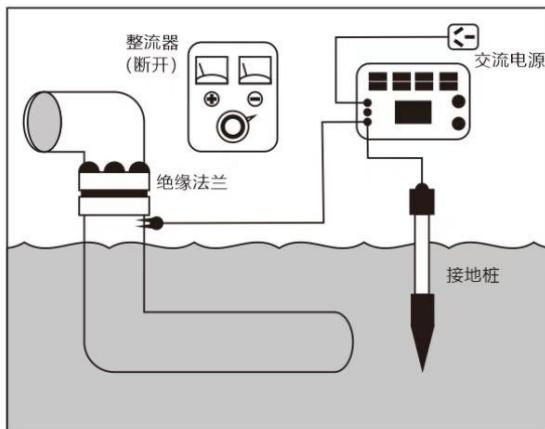
如果待测管道有绝缘接头时，将白色线上的鳄鱼夹夹到待测管道或电缆，将黄色线上的鳄鱼夹夹到绝缘接头另一侧的管道，绝缘接头另一侧可以做为合适的接地点。当没有绝缘接头时，也可以将接地点接在牺牲阳极端。
