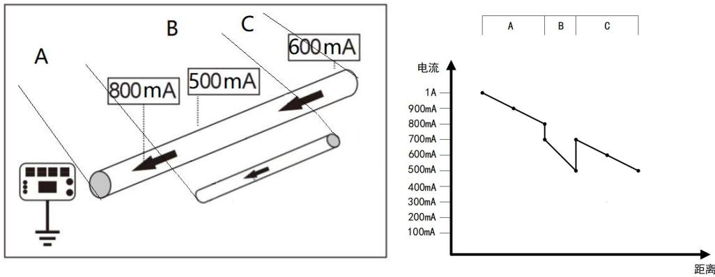
⑩、既有平行管道又有接通管道时，电流箭头指向发射机的一侧检测到接近发射机输出的电流值。另一侧则测出了一个不良的峰值和谷值，电流箭头方向背离发射机，在离发射机更远的地方也同样测出了一个不良的峰值和谷值，发现这两条管道相互短接。
