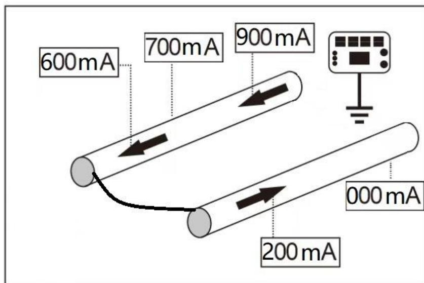
⑨、不连通的平行管道，**A** 段管道电流损耗平稳，管道表面防腐层良好。**B** 段管道电流损耗急剧下降，表明有少量电流流向相反的方向，这产生了抵消效应，导致**B** 段管道上的电流下降。**C** 段管道电流上升，之后损耗平稳，管道表面防腐层良好。
