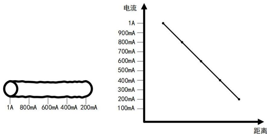
③、管道防腐层良好和不良的管道参杂在一起时，在良好的管道位置电流损耗比较平稳，在不良管道位置电流损耗会比较大。
