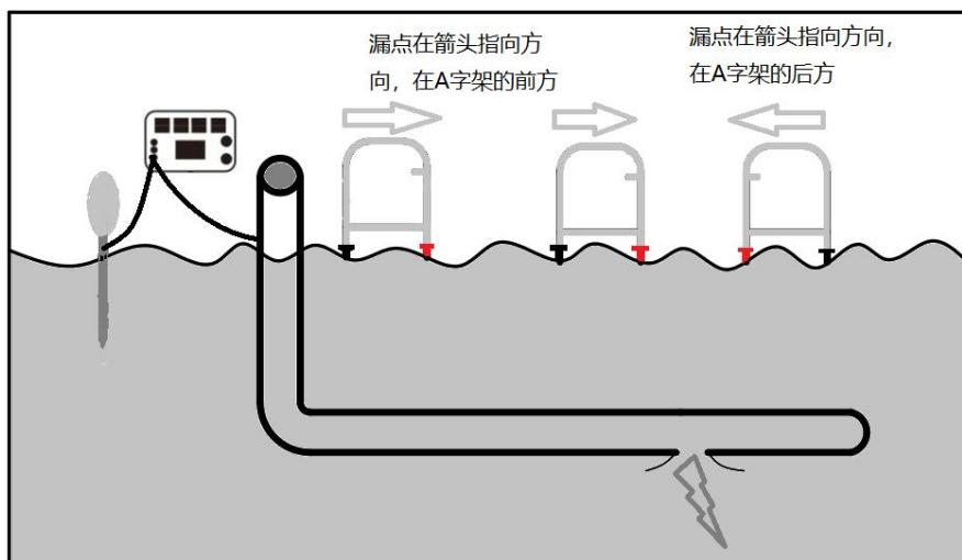
这时请将 A 字架旋转 90°，使红色插针一端指向管道，在故障点附近
