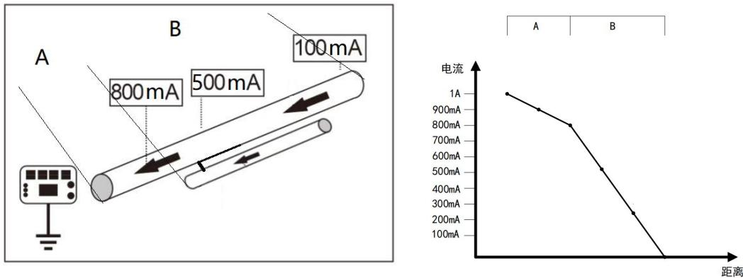
将发射机换到另一端重新测量管道电流，**A** 段管道电流损耗平稳，管道表面防腐层良好。**B** 段管道电流损耗急剧下降，说明两条管道有相互接触的点，**C** 段两条管道形成了短接的状态。
