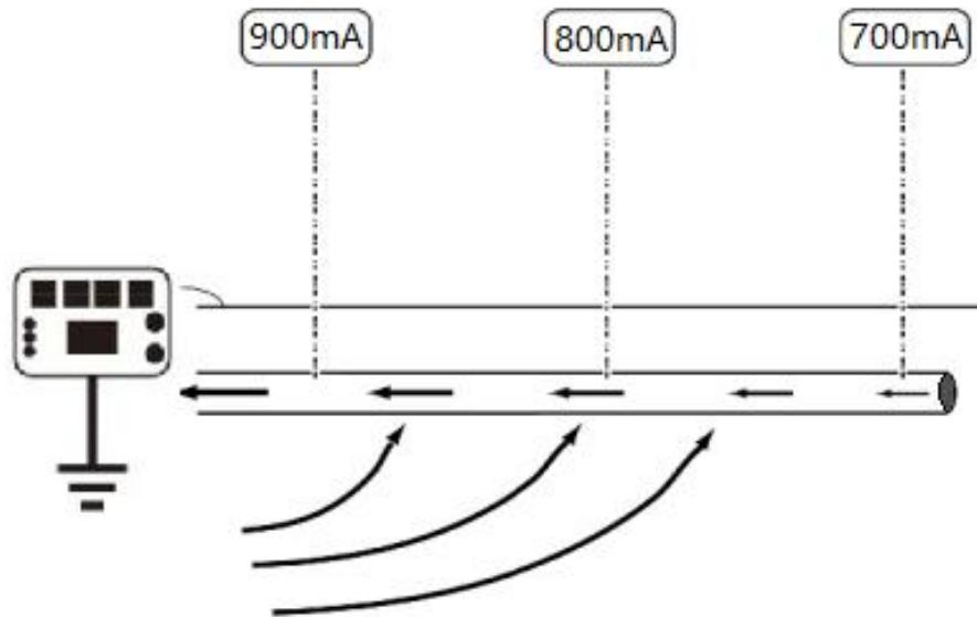
管道电流与管道埋的深浅没关系，接收机会将不同深度的管道电流值进行补偿，使的管道中的电流不随深度改变，始终保持在恒定的值。
