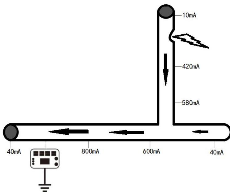
如上图所示，在接口处，有故障点的支路，电流会比其他管道电流大的多，沿着最大电流的支路管道继续探测，在支路中电流会急剧下降的点即为管道防腐层故障点。
