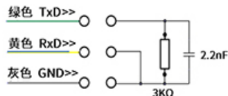
图 6 RS232 悬空不用时的接线方法
