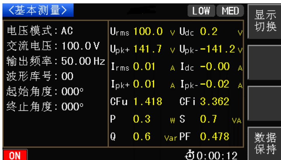
按 **ON/OFF** 输出键，可以通过软键显示切换来更改测量结果显示。
