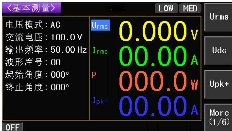
光标在<测量设置>，按方向键 $\rightarrow$ ，光标移动到测量结果参数名称，软键区可以选择 Urms、Udc、Upk+、Upk-、Irms、Idc、Ipk+、Ipk-、P、PF、CFu、CFi、PF 等参数。
