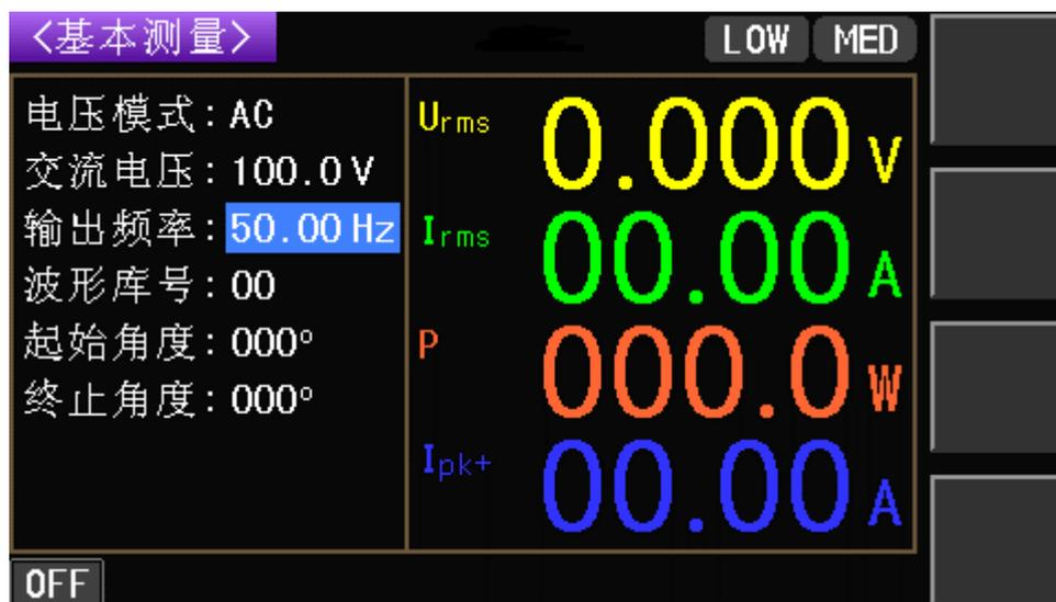
按 **F-SET** 键，光标会转到输出频率设置值，可以通过数字键盘更改设置值。在输出打开时，可以通过旋钮调节。在电压模式为“DC”时，该按键无响应。
