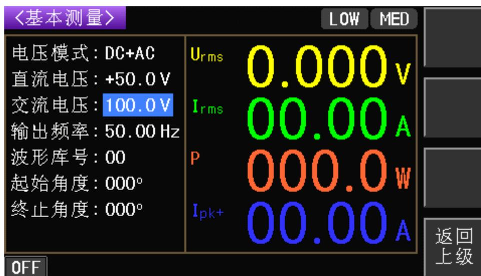
2) 按软键 **交流电压**，可以通过数字键盘更改设置值。在输出打开时，可以通过旋钮调节。
