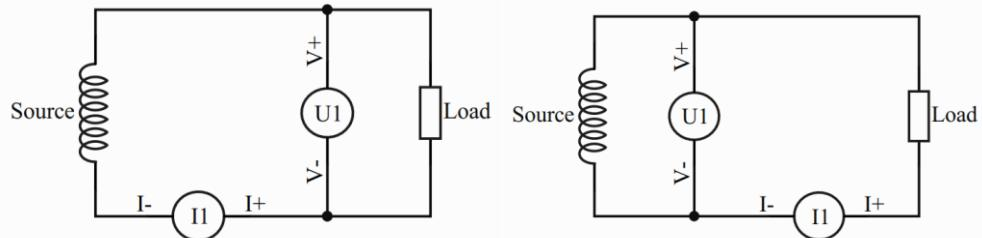
图 8-3 电流表外接(左), 电流表内接(右)——原理示意图
