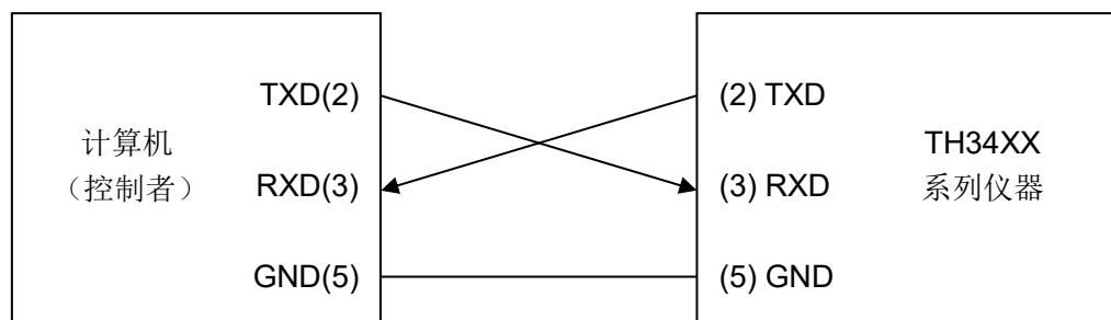
图 10-2 计算机与仪器连接示意图
