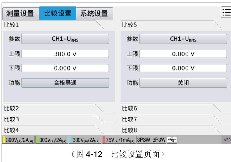
如上图所示，比较设置页面主要涉及 8 个比较通道的比较参数的相关设置，每个比较通道主要包括比较通道的比较参数、参数比较的上限、参数比较的下限以及比较功能的选择。
