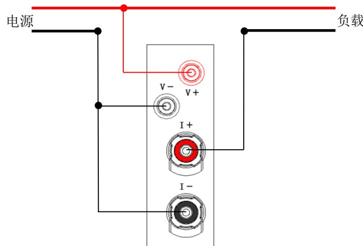
(图 8-1 电流表内接法--适用于小电流接法)
