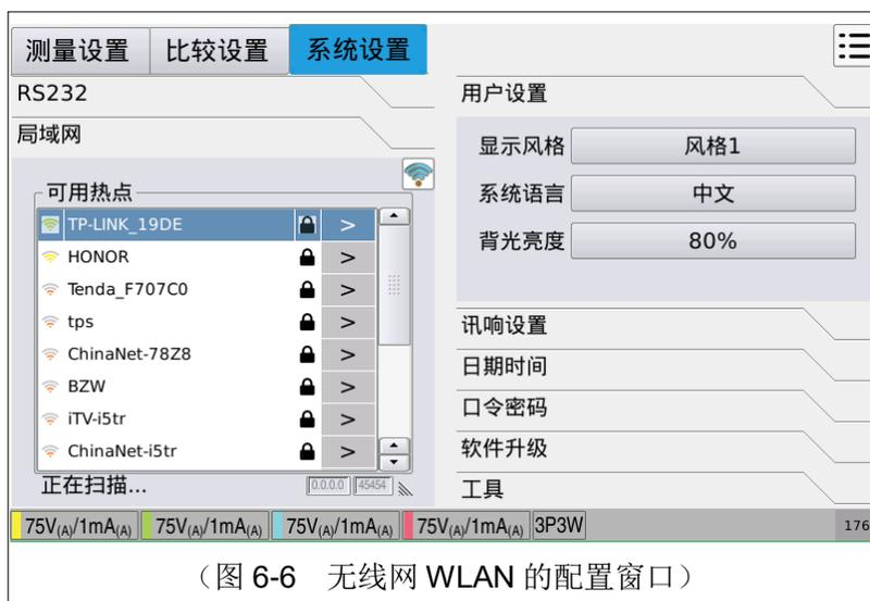
触摸可用列表的最后一列的箭头可弹出该热点的相关信息 and 无线网的相关操
