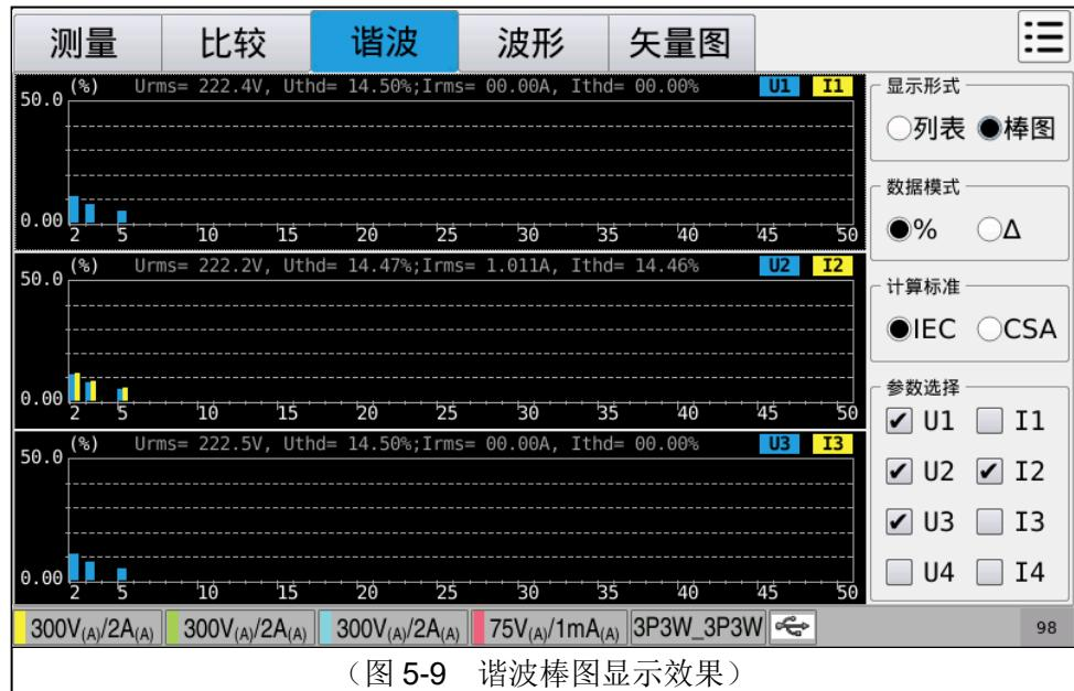
如图 5-9 所示，谐波棒显示效果，左边结果显示区域用于根据谐波分析各次谐波百分比的大小绘制的棒图显示，横坐标是枚举的谐波次数，取值范围是 2~50，纵坐标是各次谐波对应的百分比大小，棒图上方显示电压、电流有效值及总谐波大小等特定的测试结果；
