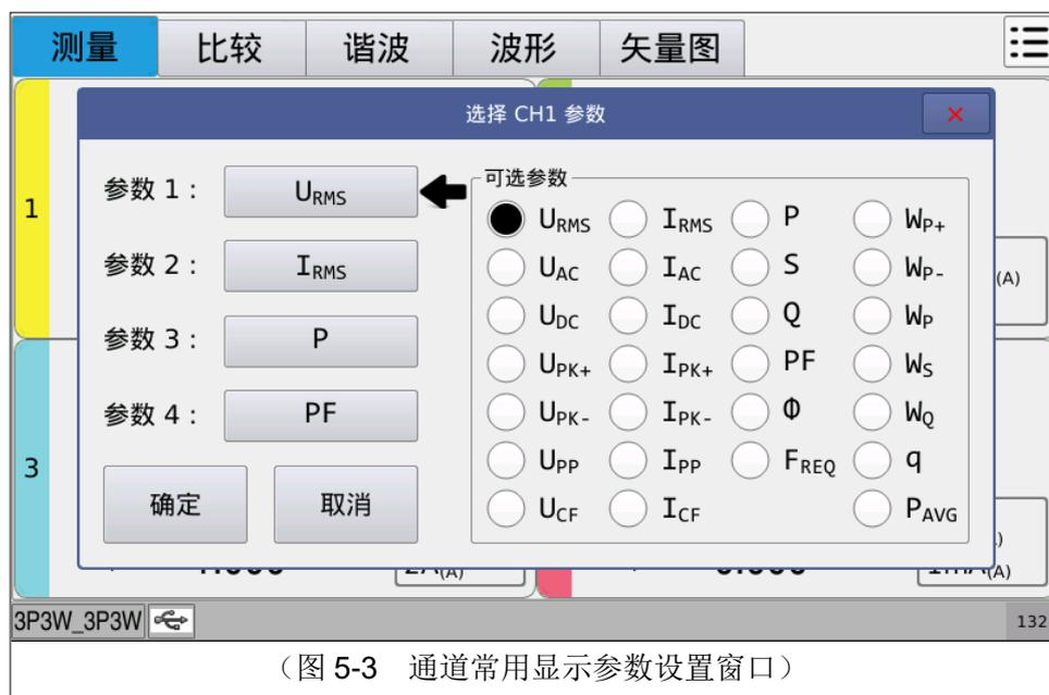
(图 5-3 通道常用显示参数设置窗口)
