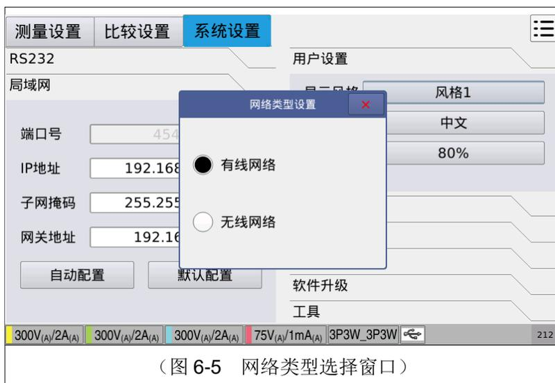
选择 WLAN（无线网络）后自动执行热点扫描操作，如果扫描到的热点中存在已保存的无线热点配置，则自动连接信号最强的已保存网络，连接成功后将会在窗口的下方显示分配好的 IP 地址以及对应的热点名称，如下图 6-6 所示：
