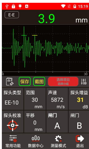
图 2 - 超声测厚 APP 的 A 扫测量界面
