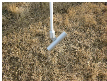
45 度法（探头于管线走向成 45 度角）
