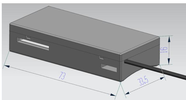
图 1.9 无源无线温度传感器 ATE300
