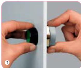
将操作头部由面板前方插入安装孔，于面板后旋入中座，然后均匀拧紧两端紧定螺钉（切不可用力过猛，最大扭力25N-cm），如面板为塑料等其他非金属材料，可在面板后垫上一块安装板（见附件F5）后再安装，如安装孔的直径为25mm时，可在面板后垫上一块 $\varnothing 25$ 的安装板（见附件F6）后再安装。
