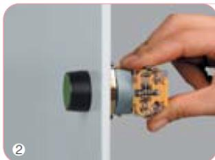
开关元件直接扣上即可，头部的符号片可直接在前部进行安装（一般在出厂时已装好）。如安装带灯按钮时，即先扣上灯座，然后再扣上开关元件。
