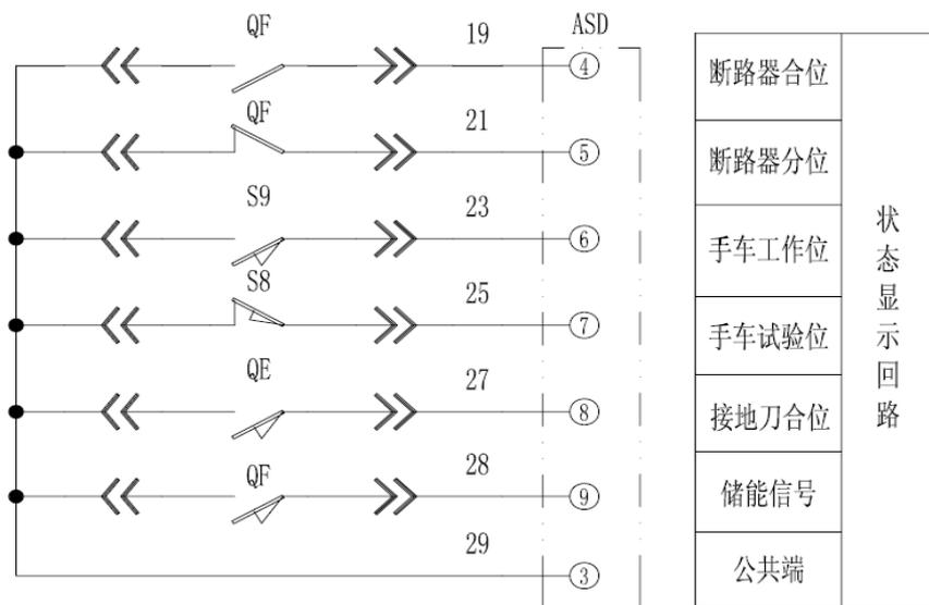
图 1.15 ASD 开关量输入回路典型接线图
