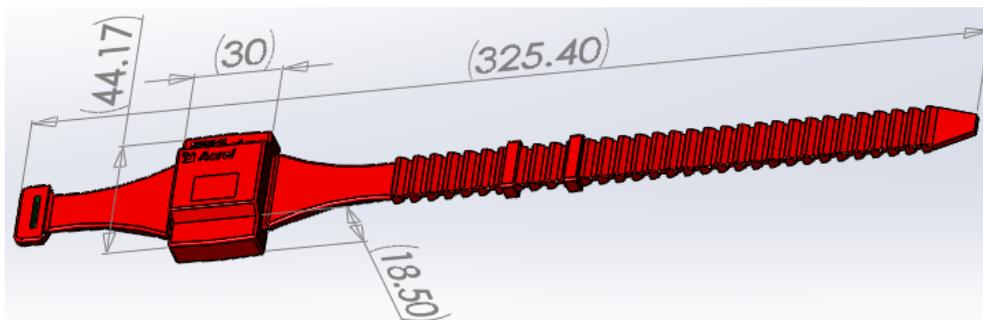
图 1.7 表带式无线温度传感器 ATE200
