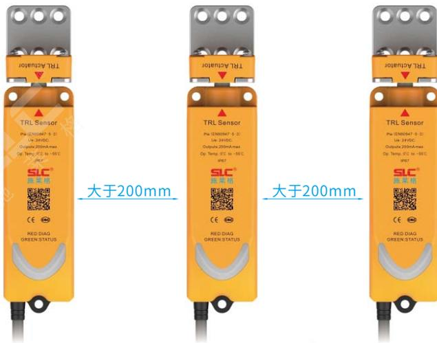
使用多个TRL2安全联锁时，可能出现相互干扰而导致TRL2安全联锁发生误动作。为防止相互干扰，请按如下规定安装TRL2安全联锁。
