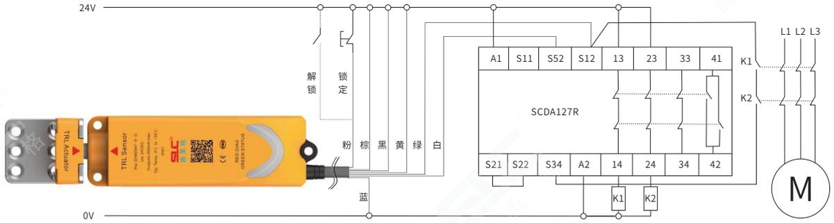
TRL2系列(PNP)上电释放型安全连锁与安全模块应用接线实例
