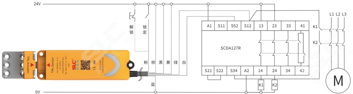
TRL2系列(NPN)上电锁定型安全连锁与安全模块应用接线实例
