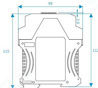
功能描述：安全继电器模块应安装在防护类型为IP54以上的电控箱内，使用DIN导轨（35mm）安装，固定在电控箱内。
