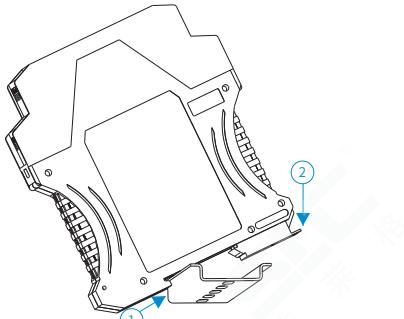
1. 将SCDA系列安全模块固定塑胶卡位斜卡入安装导轨一侧；
