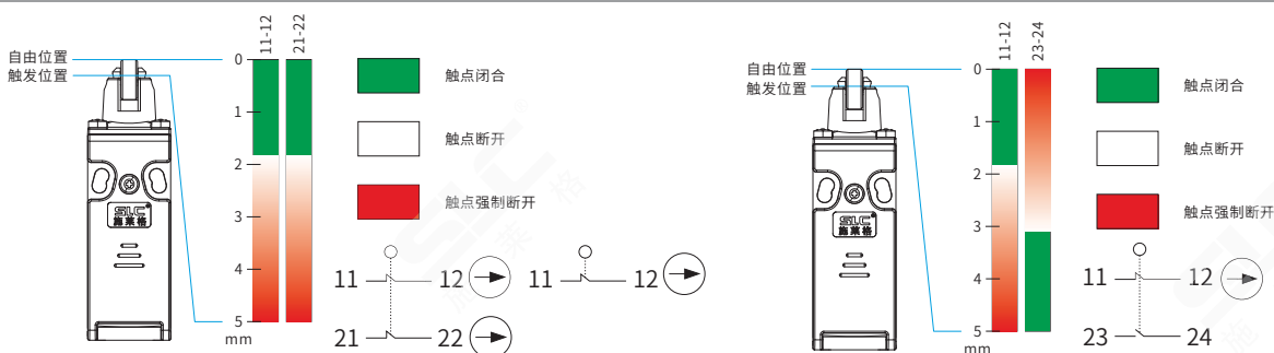
TTS2C(铰链)触头行程图
