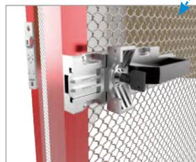
开门时，将把手向右拉到最远，锁定钥匙处于竖直状态，拔出钥匙，在此状态下既是安全门关闭，配套安全门的安全开关也无法接通，可保证安全门内人员及设备安全。
