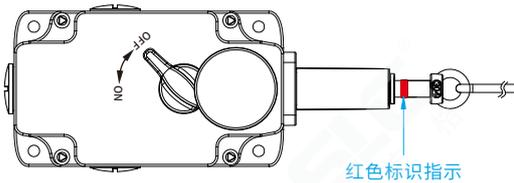
3、当出现紧急情况时，拉动缆绳（约 $190 \pm 10\text{N}$ ）或是拍下急停按钮（约 $35 \pm 10\text{N}$ ），便可实现停机，此时旋钮又回到OFF位置。如需重新启动开关，需重新调整手动复位。
