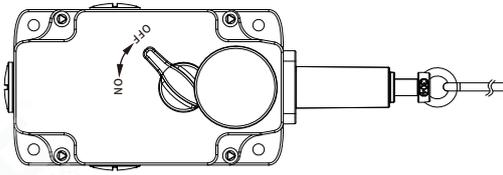
1、开关安装好后处于未启动状态，复位旋钮处于OFF位置，此时缆绳为松弛状态；
