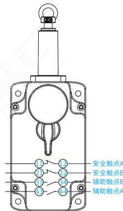
拉绳开关触点开闭与缆索松紧状态对应图
