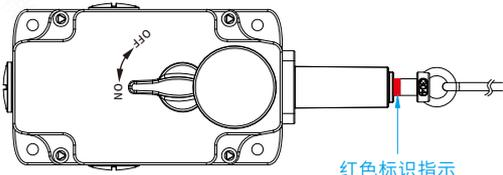
2、调整收紧器，对开关施加预紧力（约 $95 \pm 10\text{N}$ ），使得红色标识指示完全露出，此时拨动自复位旋钮至ON位置，开关便处于工作状态；
