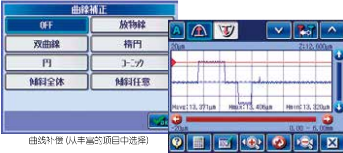
简易轮廓形状解析示例 (凸段差)
