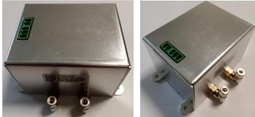
众所周知，采用非分散红外（NDIR）原理的 SF6 纯度传感器由于信号饱和，SF6 浓度在 90% 以上时，具有很大的波动性，红外原理的传感器测试 SF6 气体纯度可靠性和重复差，无法满足高压开关内六氟化硫纯度测试的要求。TCD-SF6 热导式传感器是采用 MEMS 技术设计的一款 SF6 气体纯度传感器。它通过直接测量气体热导率方式运行，无需参考气。SF6 纯度传感器具有测量范围广 0-100%Vol.，配置灵活等优势，采用恒温气室设计，可在-40℃~+50℃下保证测量准确度和重复性，且波动性很小。SF6 纯度传感器可选高精度压力补偿功能，在 0-1MPa 压力范围内提供±2%FS 的补偿精度。
