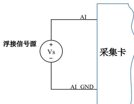
图 4-4-5 浮接信号源的参考地单端 (RSE) 连接
