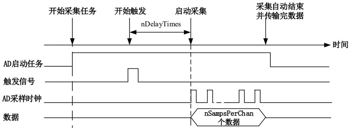
图5-2-3 硬件延时触发
