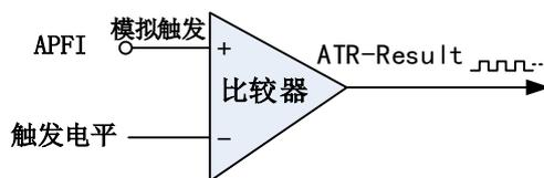
图5-3-4 模拟触发比较器
