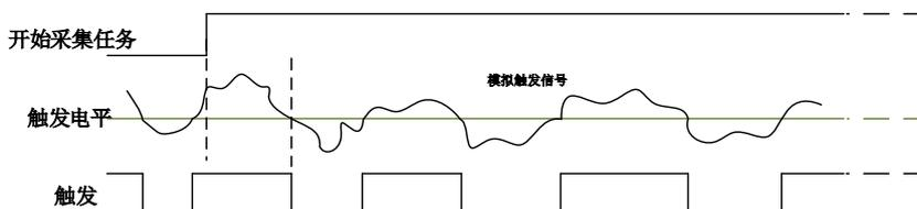
图8-3-5 模拟边沿触发--下降沿触发
