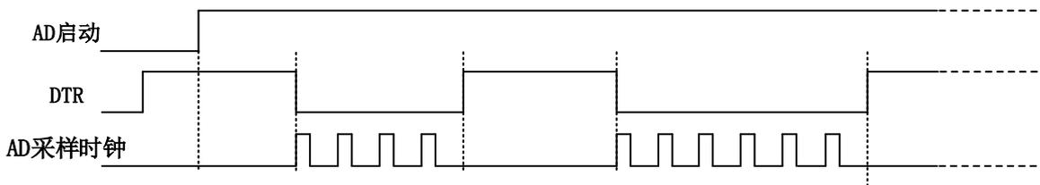
图 5-2-5 暂停触发—高电平暂停
