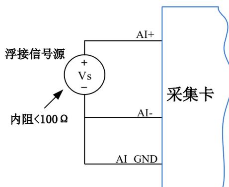
图 4-4-1 浮接信号源差分（DIFF）连接 -- 直接连接
