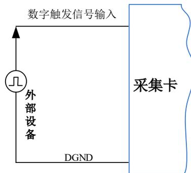
图5-3-8 数字触发连接方法
