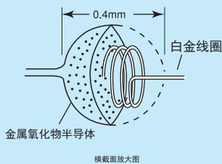
在白金线圈上烧结有直径约为0.4mm的球形金属氧化物半导体,气味分子在半导体表面发生反应,传感器电阻值发生变化,通过检测桥式电路的电压变化反映出气味强弱。
