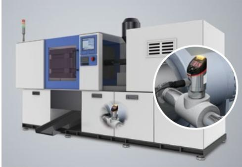
液压油缸的压力管理…防止成型不良(缺料)
