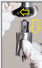
刀具卸载 刃物の取り外し
