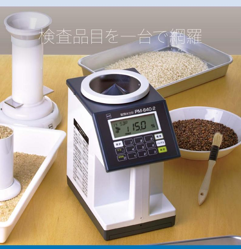
本器は、農産物検査規格指定の電気水分計・電気式穀粒 計です。測定対象は農産物検査対象品目を網羅しており ますので、一台でさまざまな品目の水分と容積重の検査が できます。また、うるち玄米については機械鑑定にも対応 しています。一部検査対象外品目の水分・容積重測定も可 能です。
