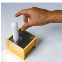
突き棒でモルタルの空隙を除く
