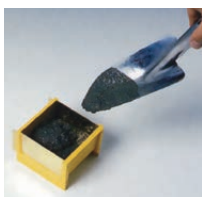
モルタルを試料ケースに入れる
