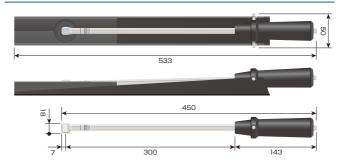
L字型プローブでも入らない、細くて長いパイプの内面の測定に。 オプションのパイプ内面測定用プローブです。
