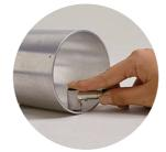
測定は、測定箇所にプローブを 垂直に押し当てますが、筒や鉄 骨の内側など、測定箇所が狭い 場合、標準プローブは長すぎて 垂直に押し当てられません。 そのような場合に、垂直に押し 当てられるオプションのL字型 プローブです。
