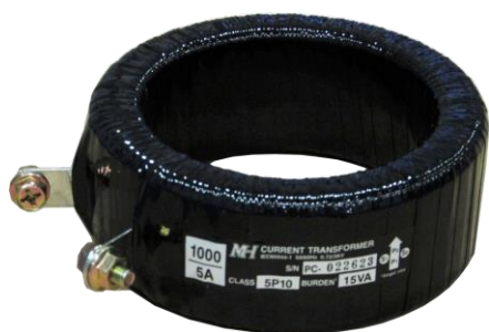
MH 电流互感器 用于低压交流网络测量的卷绕结构
