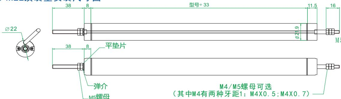
应用范围: KPM系列产品大部分是两端固定安装的微型铰接运动方式, 适合于较小机械行程且有摆动的位置检测, 对安装的对中性无任何要求, 如: 注塑机顶针、鞋机、3D座椅、预应力千斤顶、机械手臂、机器人、取出机、砖机、陶瓷机械、水闸等。
