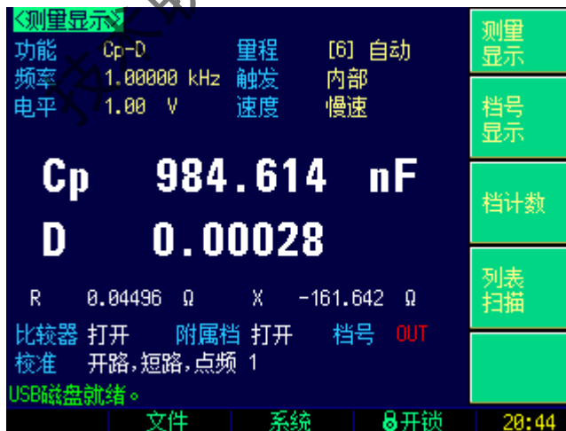
图 10-2 电容器的测试结果
