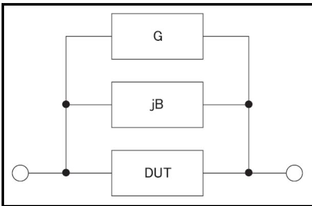
**【开路】**校准将对仪器的典型频率进行全清零。这些频率点根据仪器版本不同而不同：
