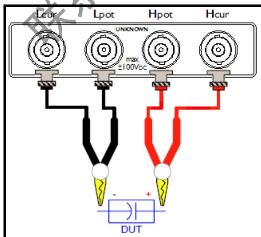
**警告:** 不要加直流电压或电流到测试端 , 否则会损坏仪器。
