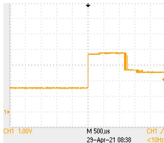
图 4-4-4 先断开后闭合的动态变化
