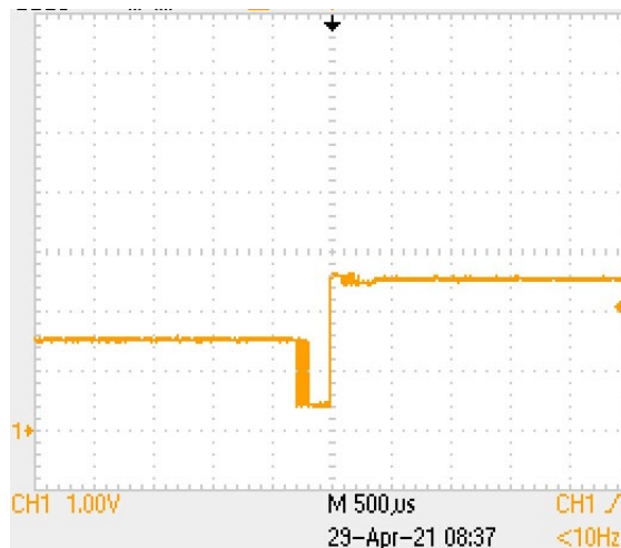
图 4-4-5 先闭合后断开的动态变化
