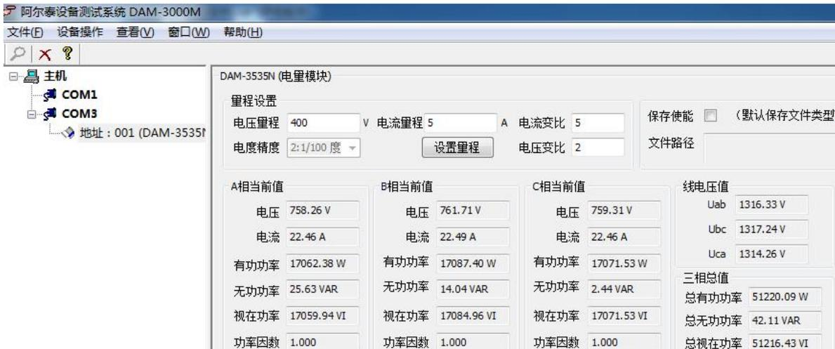
采集效果：采集电压为输入电压的 2 倍，采集电流为输入电流的 5 倍，采集功率为输入功率的 10 倍。
