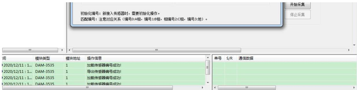
9) 传感器布好之后，需要手动调整编号顺序，使其与 A、B、C、GND 对应起来。点击旧编号的下拉箭头选择要修改的编号，点击匹配编号，选择新编号，点击 OK。
