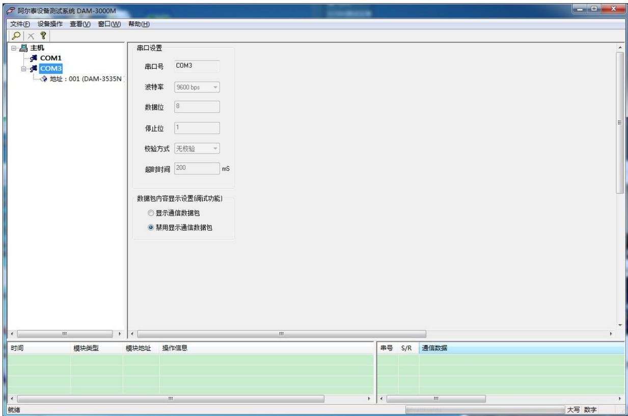
3) 点击模块信息则出现采集界面，电压变比和电流变比可配置。
