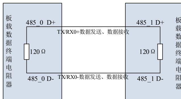
图 4-1-3 RS485 信号连接
