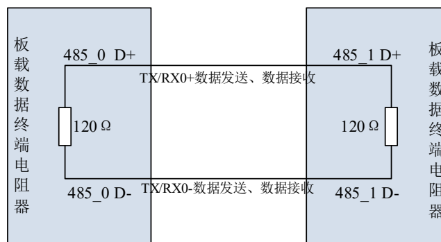
图 4-1-3 RS485 信号连接
