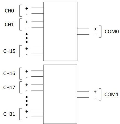
图 3-3-4 2 线两组 16×1 拓扑结构图
