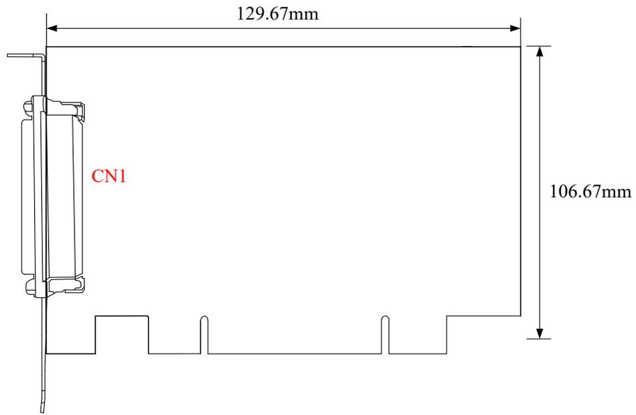
图 3-1-3 PCI2612 尺寸图
