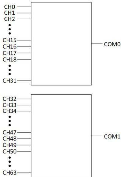
图 3-3-2 1 线两组 32x1 拓扑结构图
