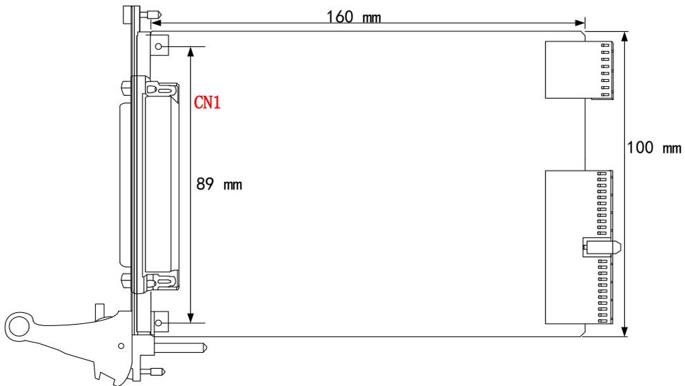
图 3-1-4 PXI2612 尺寸图
