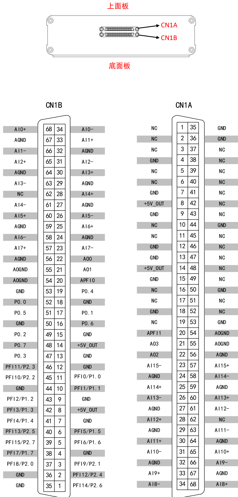
图3-3-1 NET9784/A/B CN1连接器管脚定义
