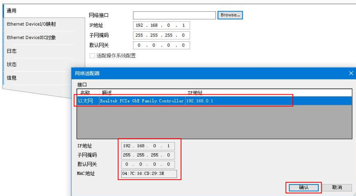
i. 双击项目树中的“EIP\_3200\_D”，单击“通用”，查看“IP 地址”如下图所示，与初始化设置地址保持一致（参考上电及初始化中修改 IP 参数配置），否则需要重新对板子进行初始化配置。
