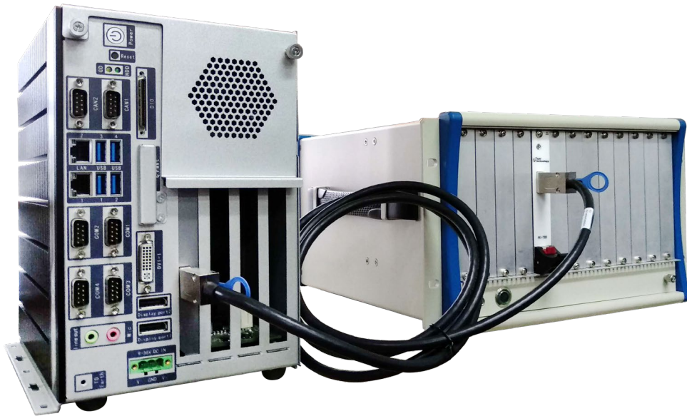
PXI-7300 与 PCIe7310 组合搭建 PCIe 信号远程传输组建 PXI 测控系统
