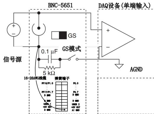
图 4-1-3 测量一个单端模式下的浮接信号
