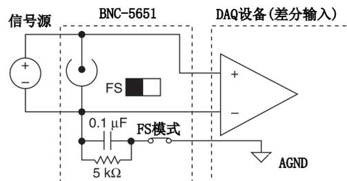
图 4-1-1 测量一个差分模式下的浮动信号
