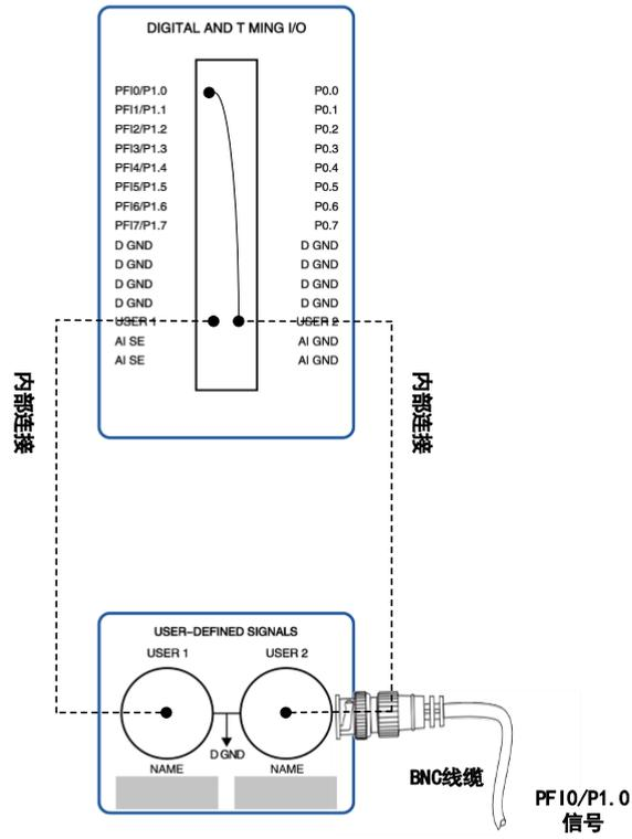
图 4-4-2 USER<1..2>BNC 连接示例
