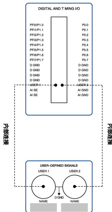
图 4-4-1 USER<1..2>BNC 连接器内部连接
