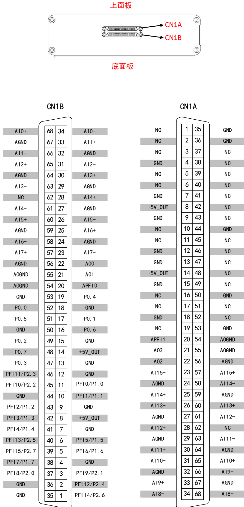
图3-3-1 NET978x CN1连接器管脚定义
