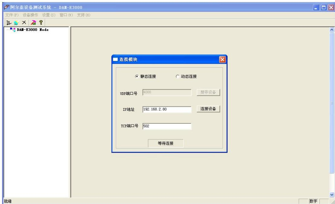
动态连接：动态连接不需修改端口号， 默认即可，点击搜寻设备。
