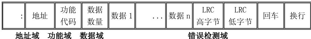
**帧定界:** 在 MODBUS ASCII 方式下, 一个 8 位的数据使用两个 ASCII 字符来表示。比如 16 进制的 0x3A 用字符“3”和字符“A”表示。其中“:”表示帧的起始, “CR LF”表示帧的结束。
