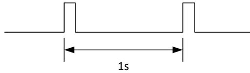
图 5-1-1 秒脉冲波形示意图
