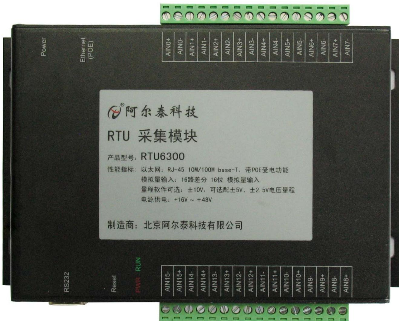
AIN0+/-~AIN15+/-：分别为 16 路模拟量差分信号输入端，输入电压值±10V（也可选配±5V、±2.5V 量程），带 12V TVS 保护
