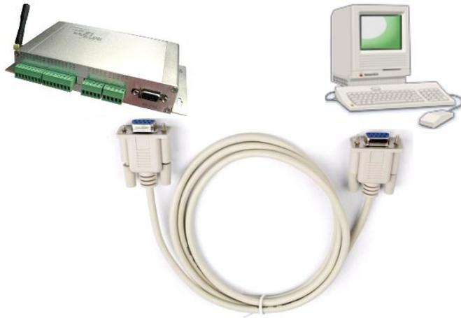
图 3.1.1 本地串口配置示意图
