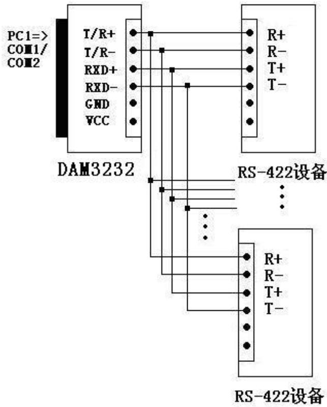
3、DAM-3232H 接口转换器之间全双工通信连接
