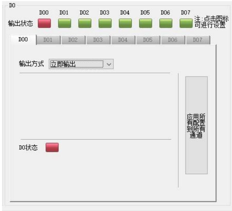
② 低到高延时输出：设置延迟时间后改变输出状态，当输出为低电平到高电平时（即图标为绿色变为红色），输出信号的时间会按照设定的参数延长。
