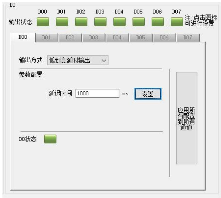
③ 高到低延时输出：设置延迟时间后改变输出状态，当输出为高电平到低电平时，输出时间会按照设定的参数延长。
