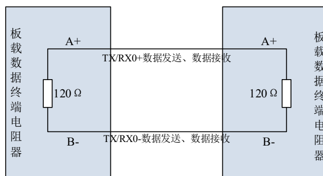
图 4-1-3 RS485 信号连接
