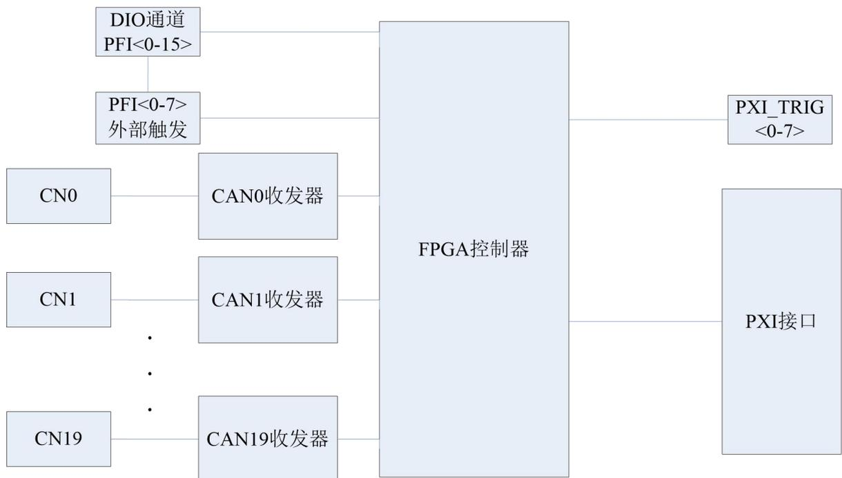
图 2-2-1 PXI4004 系统框图
