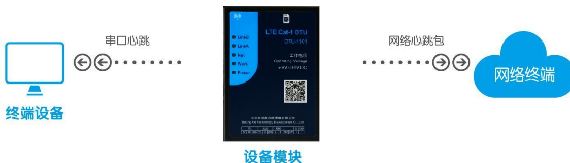
图 31 心跳包功能示意图（串口心跳移动至自定义轮询功能）
