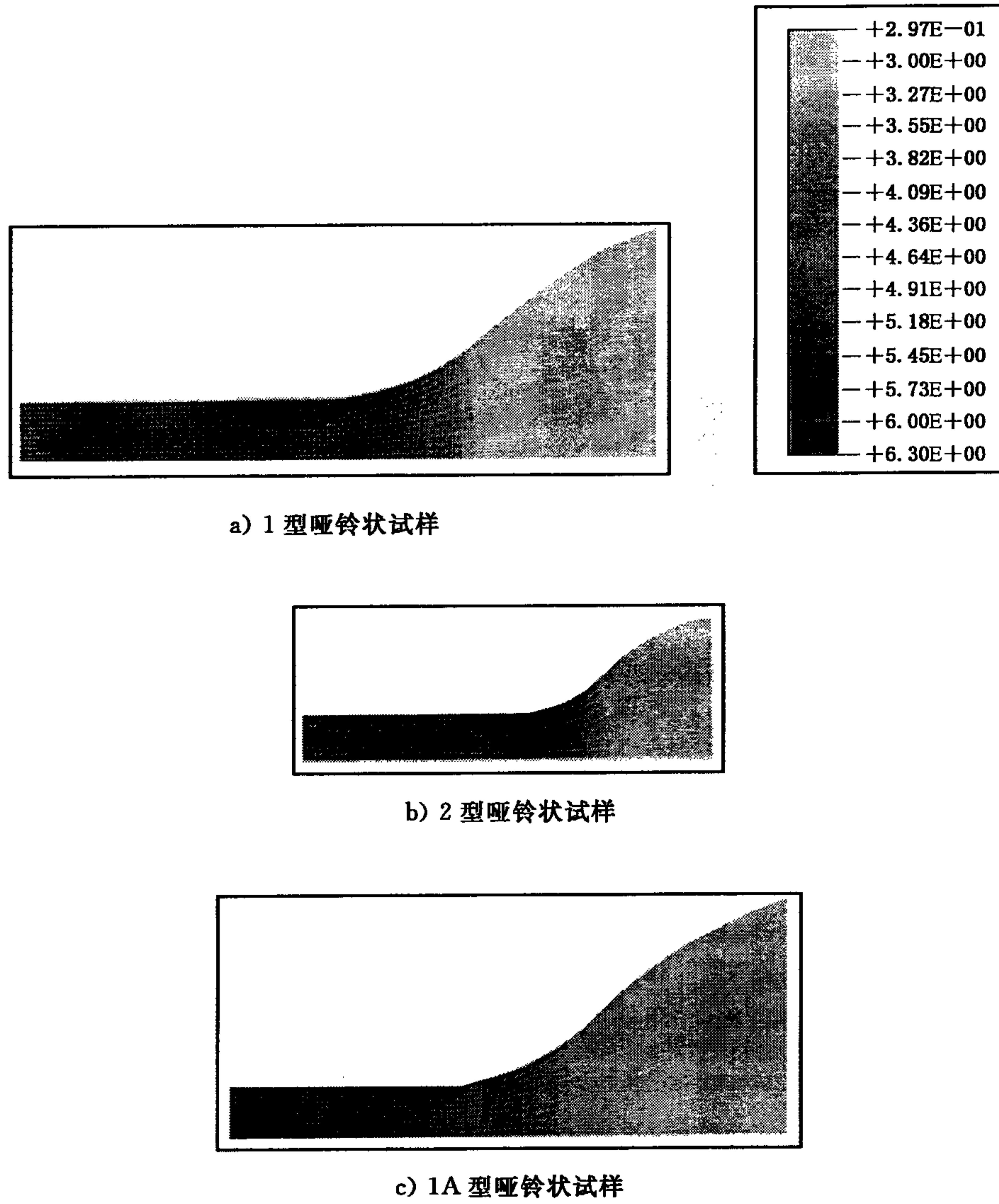
图 C. 3 使用“ABAQUS”获得的应变分布实例
