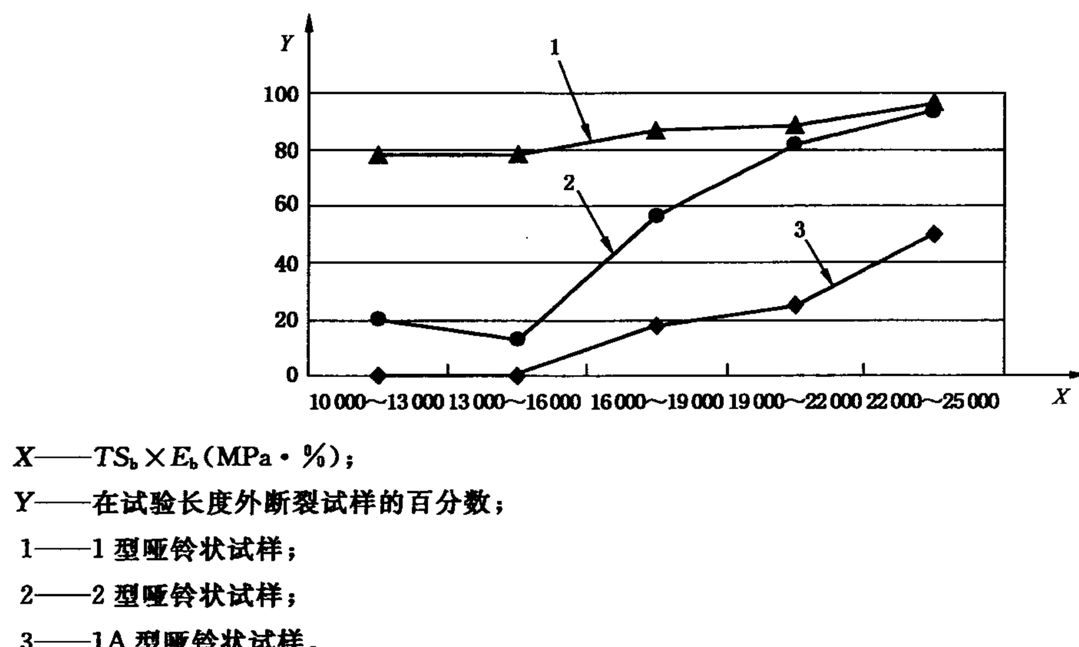
**图 C.2 试验长度外断裂试样的百分数与  $TS_b \times E_b$  (拉伸能) 的关系**
