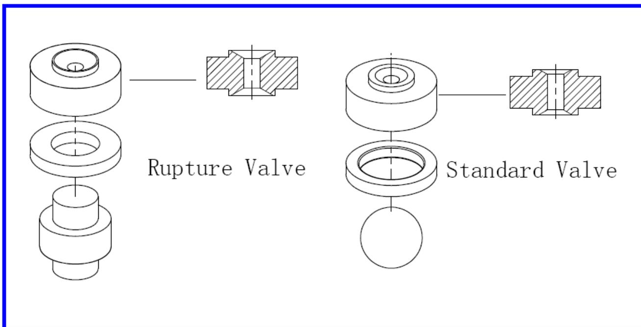
**AH-NANO** 均质机提供两套均质阀：一套破碎阀，一套乳化阀。
