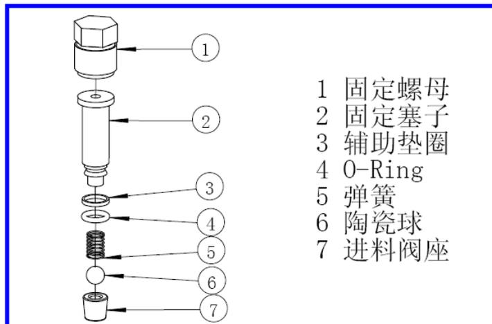
压力块采用高等级双相合金不锈钢制造，确保在高的操作压力下的良好的抵抗应力疲劳，容易拆卸和安装的设计。
