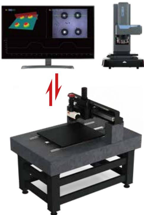
DMZ1000 D采用了性能优异的直线电机系统,突破了步进电机、伺服电机平台在尺寸、精度和速度的限制。
