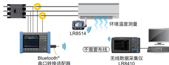
※ 仅 PQ3100 支持。连接时需要使用我司推荐的串口 -Bluetooth® 无线技术转换适配器。详情请垂询。
